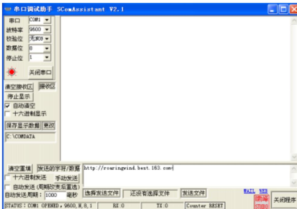
您如果要调试无线模块通信，需要在两台计算机上安装此调试工具，分别利用两台计算机的串口，或者在一台计算机上利用两个串口进行调试，在同一台机器上须运行两次串口调试助手，选用不同的串口。
